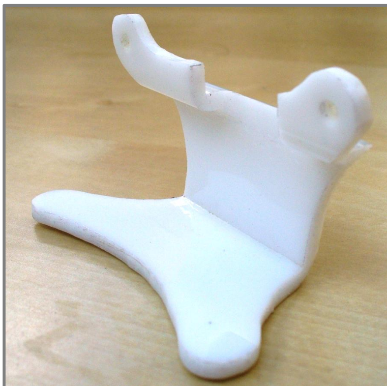
#7 Požadovaný tvar stojan dostal natvarováním po nahřání horkovzdušnou pistolí a finálním přebroušením oblých tvarů.
