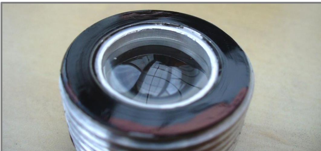
*16 Do kolimačního šroubu byla vložena asférická čočka a zajištěna vnitřním kroužkem přilepeným ke kolimačnímu šroubu disperzním lepidlem.
