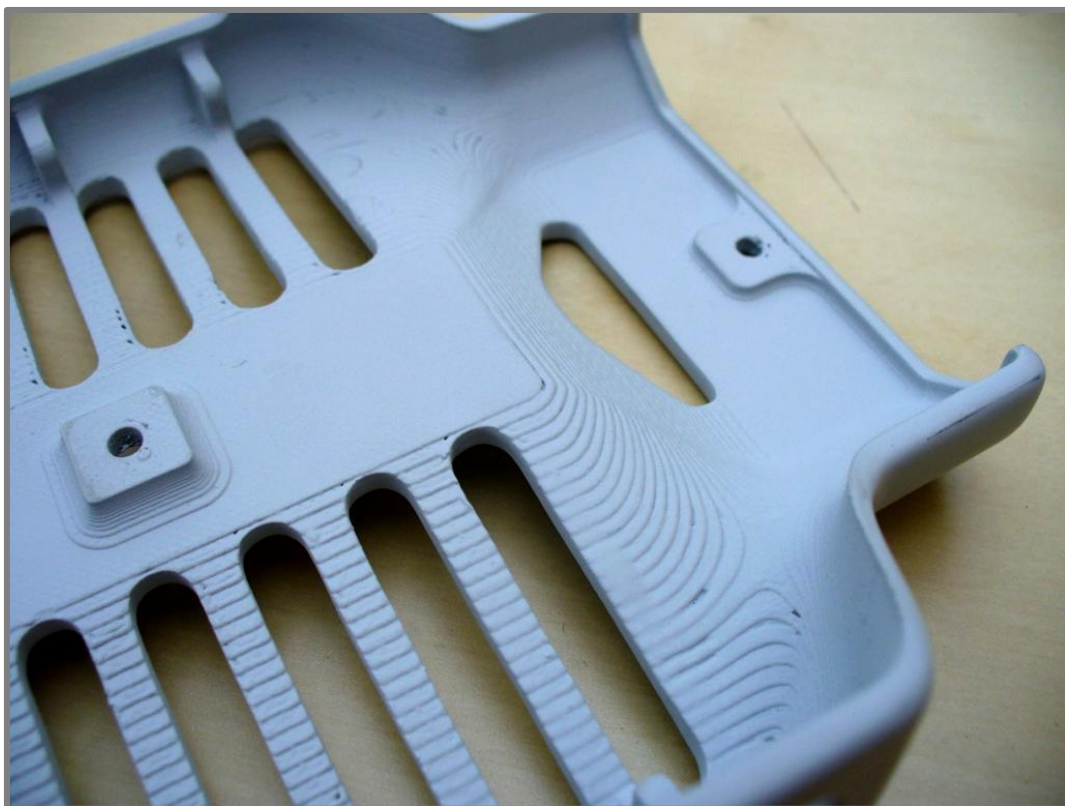
#10 Patrná struktura povrchu oblých tvarů – pro vzhled výrobku nežádoucí.
