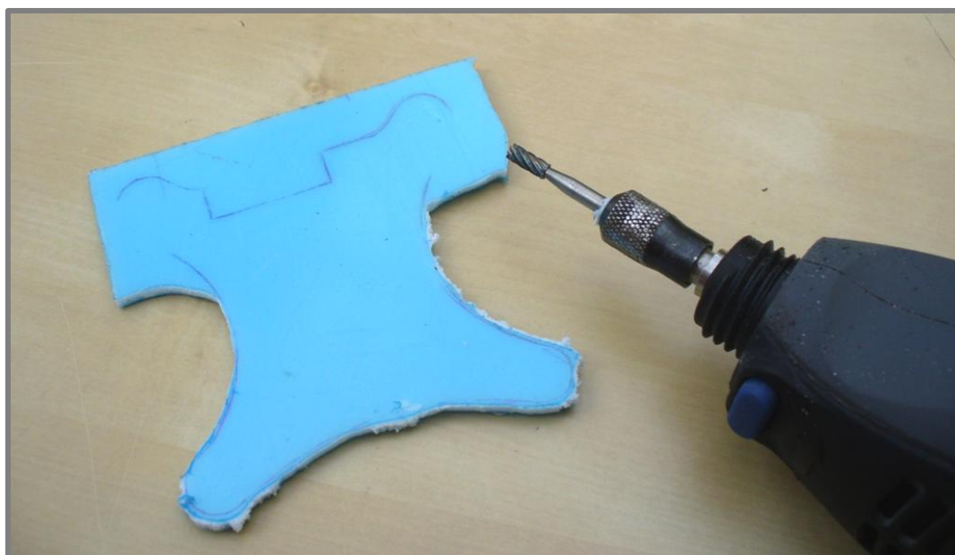
#6 Stojan nebyl vytvořen pomocí 3D tiskárny (výrobní výkresy) ale z důvodu možné vyrobitelnosti z tabule ABS plastu, ze kterého byl vyříznut jeho rozvinutý tvar pomocí ruční frézky.
