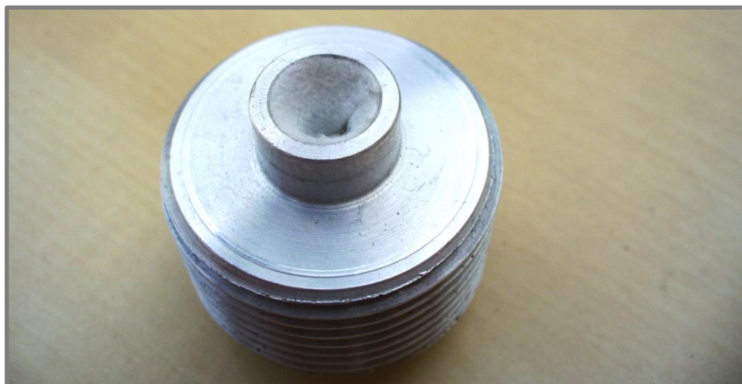
#2 Středící přípravek s vlepenou netkanou textilií bránící poškrábání čočky LED diody.
