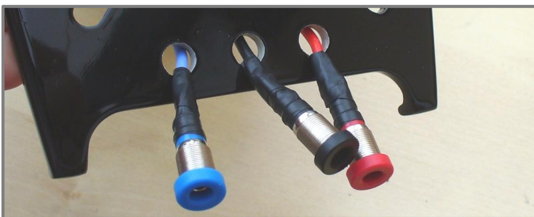
*13 Vodiče byly protaženy děrami v bočním krytu, připájeny k panelovým banánkovým zdírkám a zaizolovány elektrikařskou páskou.
