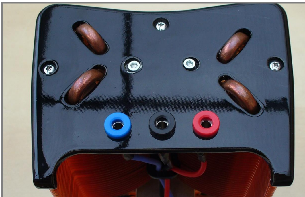
*14 Boční kryt byl s utaženými panelovými zdírkami připevněn k hlavnímu krytu a k žebrům chladiče.
